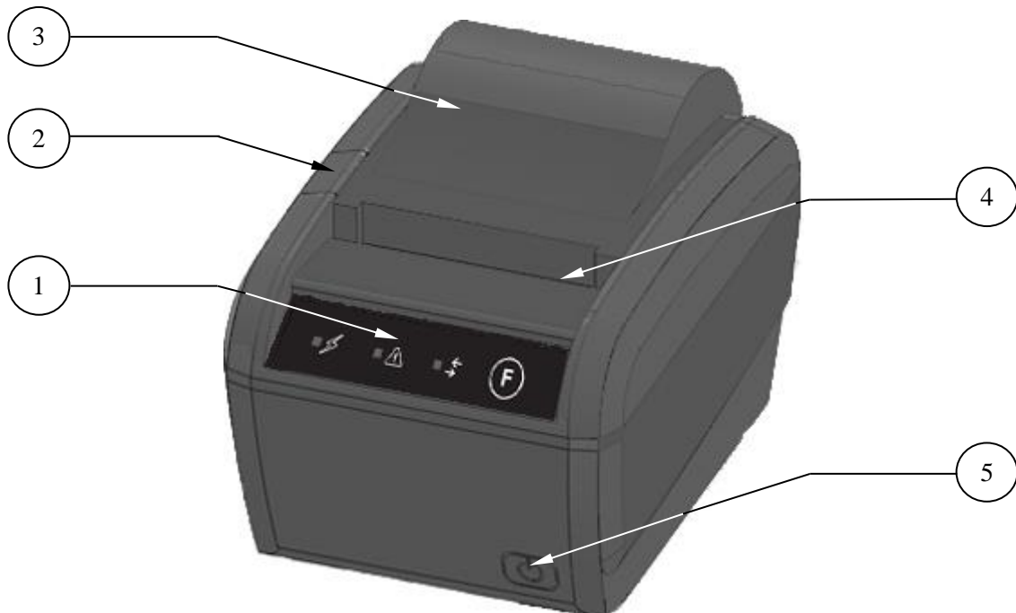
Рис. 1 Зовнішній вигляд фіскального реєстратора МІНІ-ФП82.01
